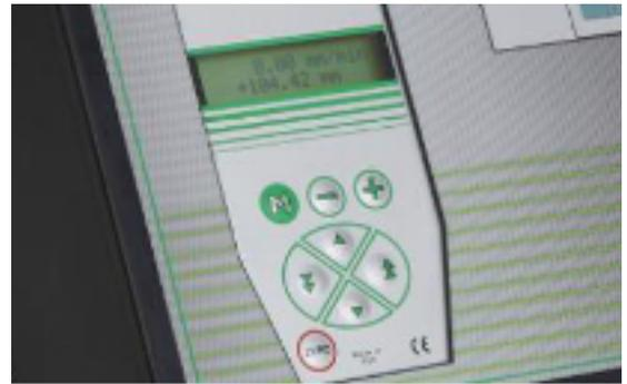
La commande de pilotage manuelle permet de déplacer la traverse de la machine d'essai pour se mettre en position avant les mesures ou pour ajuster les premiers essais.
